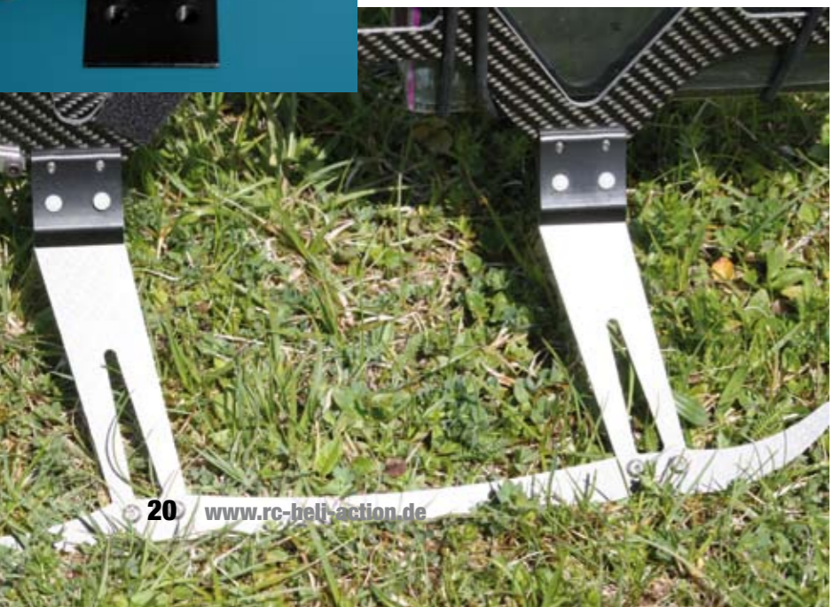
Die Kufen des Voodoo bestehen aus CFK-Frästeilen. Deutlich zu erkennen sind auch die Nylonschrauben an der Kufenklemmung (weiße Punkte), die als Sollbruchstellen dienen
