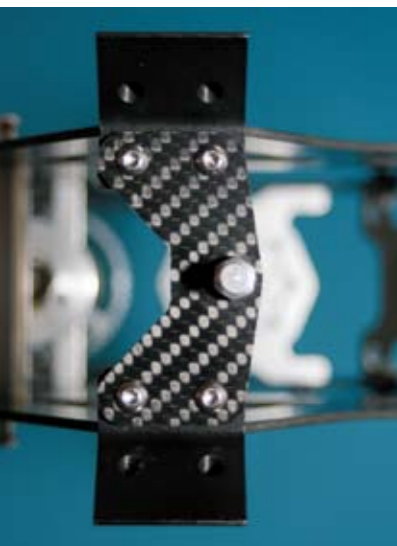
Die Halterung der Kufenbügel erfolgt durch ein Delrin-Frästeil. Die quer eingesetzte CFK-Platte versteift das Ganze nochmal
