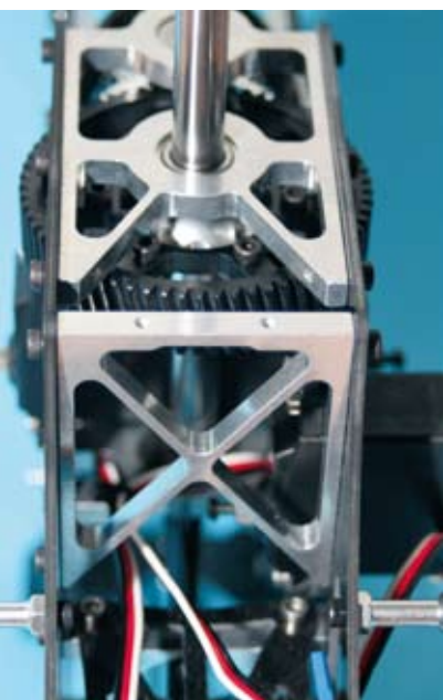
Die Domlagerplatte und die senkrechte Versteifungsplatte sorgen im Wesentlichen für einen steifen Aufbau der Mechanik
