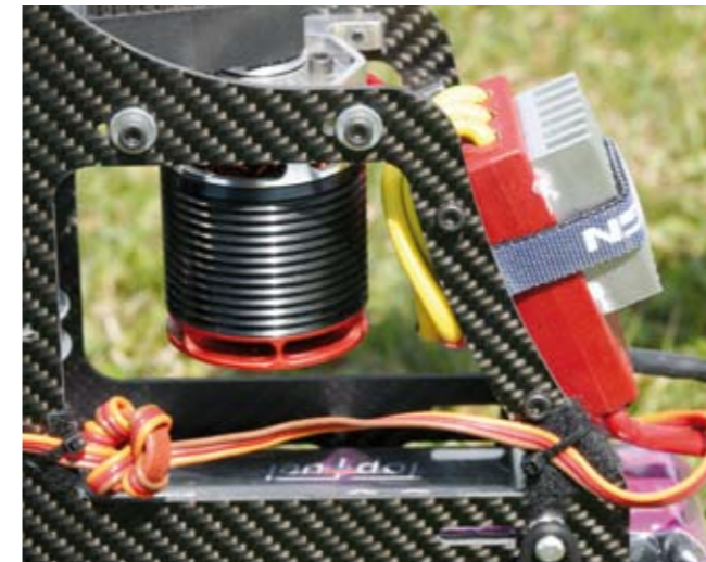
Der Kontronik Pyro 600-11 mit dem aufgesetzten Zahnriemenrad der ersten Getriebestufe. Ganz vorne der auf dem Alu-Träger befestigte Controller Kontronik Jive 100 LV. Die Akkus sitzen bereits im Schacht und sind mit O-Ringen gesichert
