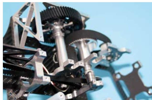
Der Heckantrieb erfolgt über Zahnriemen. Gut zu erkennen sind auch der vordere Lagerbock des Heckrohrs und die darüber liegende Versteifungsplatte hinter der Rotorwelle
