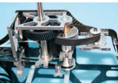
In der Domlagerplatte sind die oberen Lager der Rotorwelle und der Zwischenwelle integriert. An der Motorplatte erkennt man die vielfältigen Bohrbilder, um die unterschiedlichsten Motoren einsetzen zu können
