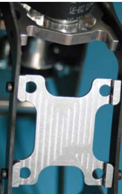
Die vorne angebrachte Lagerplatte für den Controller ist ebenfalls aus Alu gefräst und dient gleichzeitig als Kühlkörper
