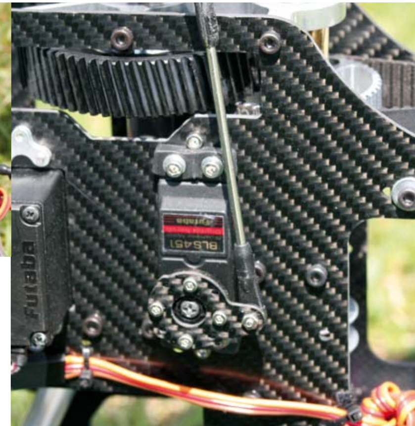
Die 120-Grad-Taumelscheiben-Anlenkung. Auf die Servoscheiben werden spezielle CFK-Hebel aufgeschraubt, mit denen sich die richtig auf AC-3X abgestimmten Hebelverhältnisse ergeben
